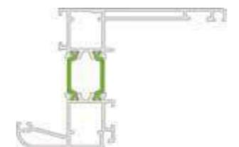
Dormant RENOVATION avec aile de 60 mm
