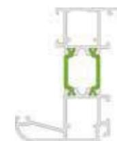
Dormant NEUF avec aile de 9 mm
