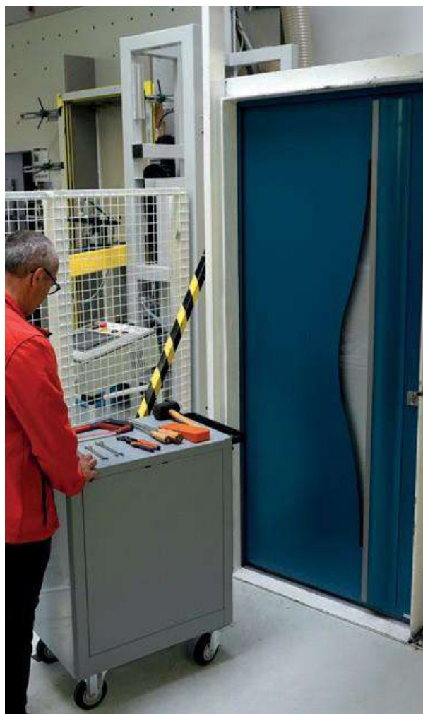
Outils normalisés pour les essais de résistance à l'effraction.
