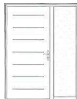
ÉQUATION LARGEUR MAXIMUM AVEC FIXE H 2150 L 1600 FERRAGE UNIQUEMENT SUR DORMANT
