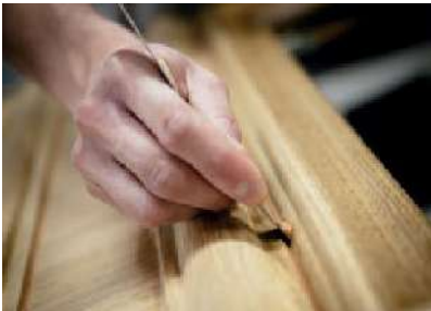
Pointe inox, rebouchage et ponçage à la main avant application de la finition.
